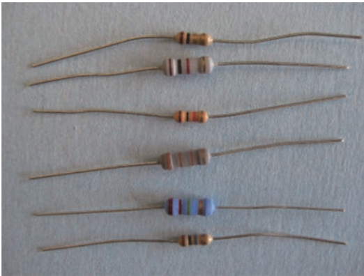
Rysunek 5.1. Rezystory mają różne rozmiary i wartości znamionowe
