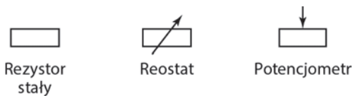
Rysunek 5.8. Symbole do oznaczania rezystorów
